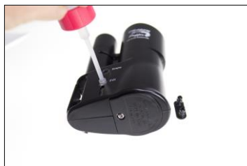
Fig. 38: Remplissage du réservoir avec du liquide fumigène
